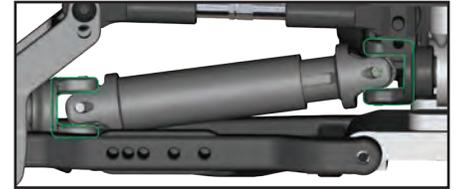
Corrija la alineación del eje de transmisión en la unión U.
